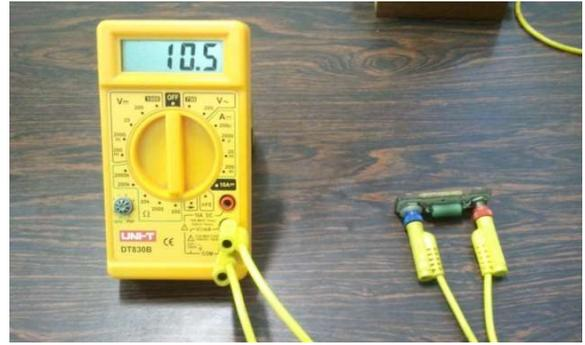
Figura 2.2: Leitura da resistência elétrica de um resistor. As mãos não devem tocar simultaneamente as duas pontas de prova.
