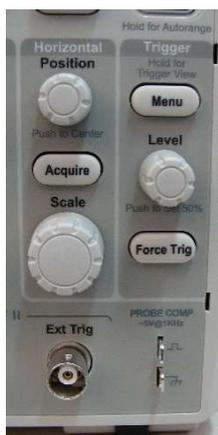
Figura 3.8: Detalhes do controle horizontal e do sistema de gatilho de sinal do osciloscópio.
