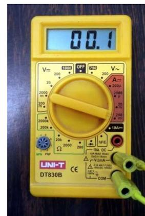
Figura 2.8: Multímetro configurado como amperímetro para leitura de corrente elétrica com fundo de escala de 200 mA.
