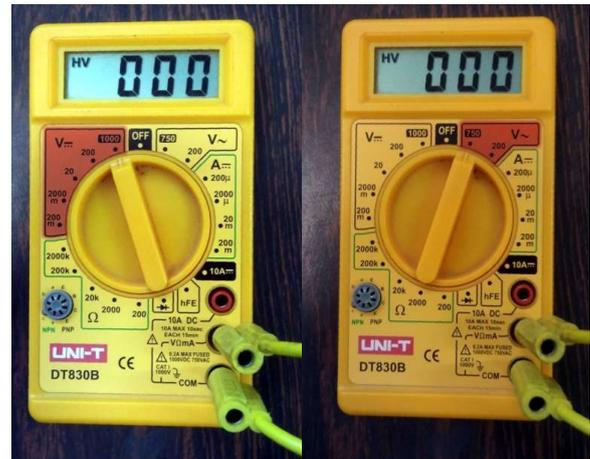
Figura 2.3: Multímetro configurado para leitura de tensão. A imagem da esquerda a chave seletora está posicionada para realizar medidas de tensão contínua e a imagem da direita selecionada para medição de corrente alternada.
