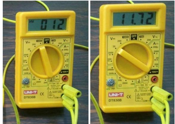
Figura 2.5: Multímetro configurado como voltímetro para medida de tensão. A imagem à esquerda mostra leitura realizada com o fundo de escala para 1000 V e a imagem da direita a leitura para a mesmo valor de tensão só que com um fundo de escala de 20 V, onde é possível observar uma maior resolução da medida.
