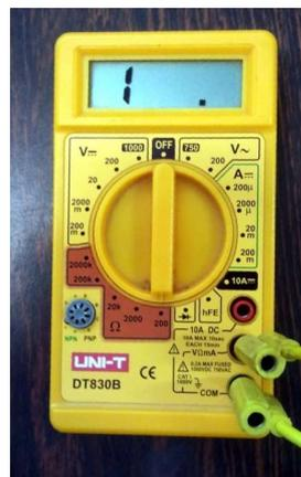
Figura 2.1: Multímetro configurado como ohmímetro para leitura de resistência elétrica. As escalas para média de resistência elétrica estão destacadas em coloração mais escura. As pontas de provas devem ser ligados nos terminais COM e V- $\Omega$ -mA para realizar a medida.
