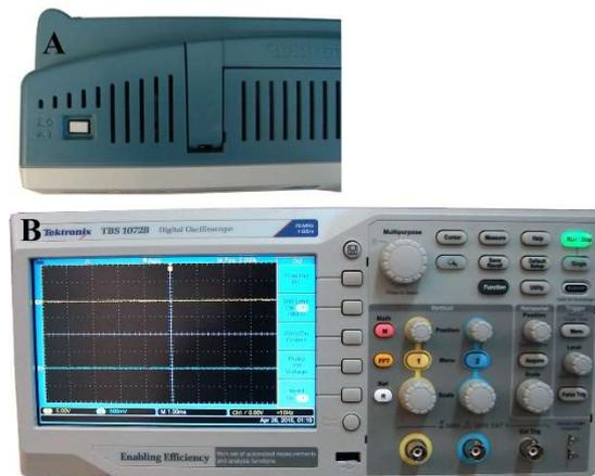
Figura 3.1: Osciloscópio digital de duplo canal para medida de sinais elétricos alternados de até 70 MHz.
